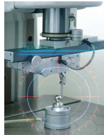
Mesure de la sphéricité Marque : Talyrond 73 HPR
